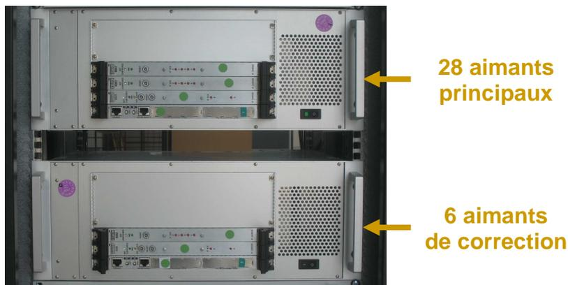
Figure 15 : Châssis d'acquisition de données
