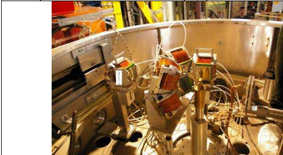
Vues du plateau de la chambre SPEG avec les télescopes (expérience E525S de 2007, ^8\text{He}(p,t)^6\text{He} )
