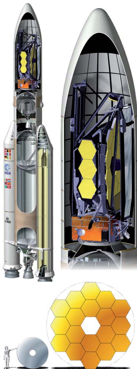
5. Comparaison entre les miroirs du HST (à gauche) et du JWST qui sera plié pour tenir dans l'habitacle de la fusée Ariane.
