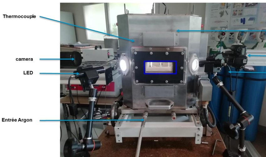
Essai sous atmosphère contrôlée (flux d'argon)
