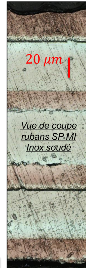
État de surface ruban SP HTS côté supra
