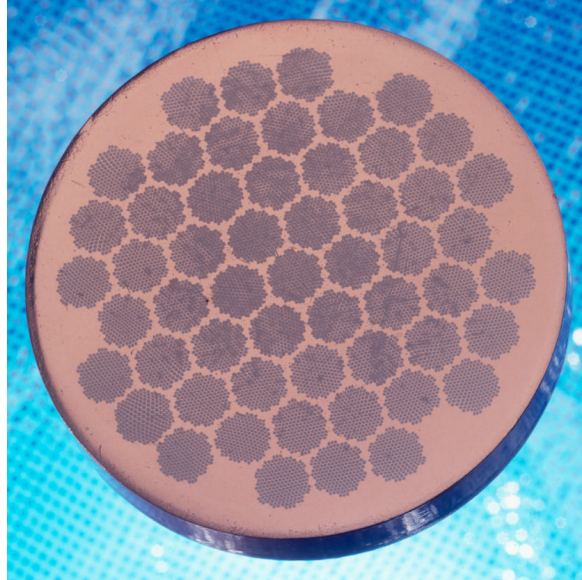
Figure 16. Fil constitué de filaments de niobium-titane dans une matrice de cuivre produit par un procédé de double empilement.
