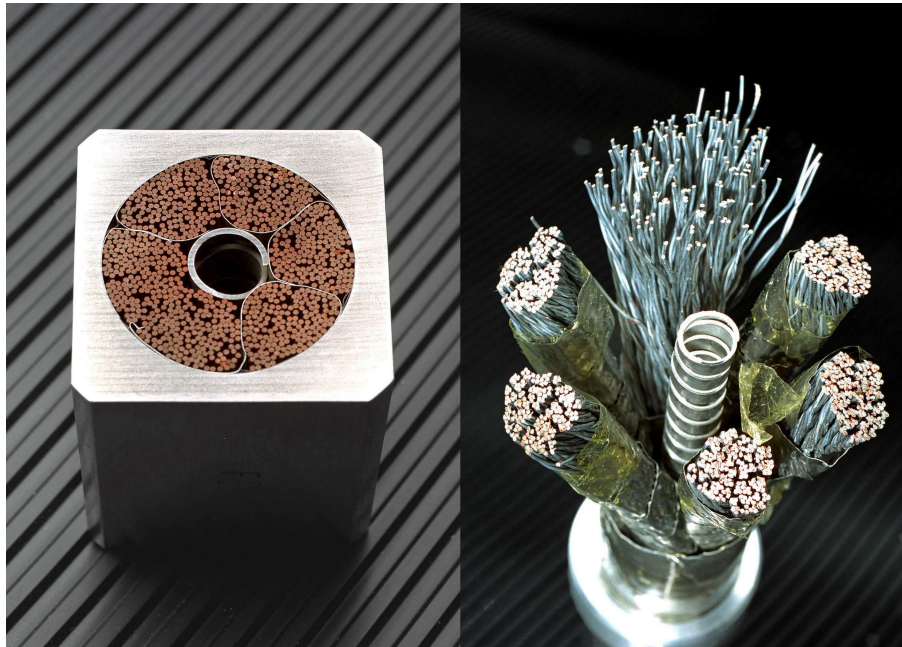
Figure 41. Conducteurs de type Câbles-en-Conduit (CIC) pour les bobines modèles d'ITER : (a) vue en coupe d'un conducteur CSMC, constitué d'un câble Nb_3Sn torsadé à plusieurs étages inséré dans un conduit de forme rond-dans-un-carré en Incoloy 908 (photo de gauche) et (b) vue explosée d'un conducteur TFMC constitué d'un câble Nb_3Sn torsadé à plusieurs étages inséré dans un tube en acier austénitique 316LN (photo de droite) [DUC 02].
