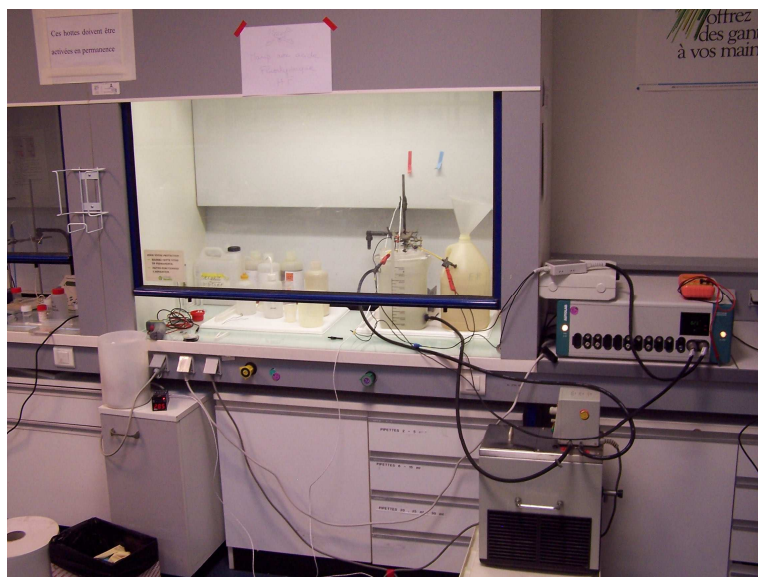
Figure 2 : vue globale de l'expérience, avec le bécher contenant l'acide sous sorbonne, le crothermostat au premier plan et le potentiostat posé à droite de la sorbonne.
