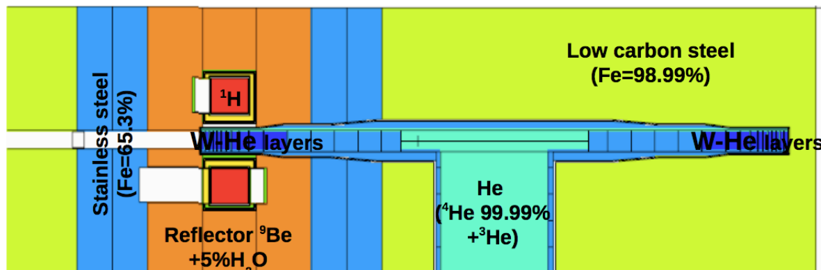
FIGURE 3.33 – Exemple de géométrie de la cible ESS modélisée dans MCNPX.
