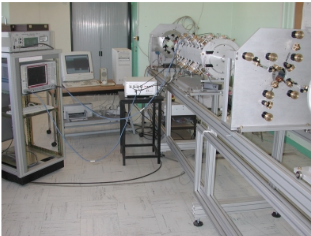
figure 4 : banc de mesure par perturbation
