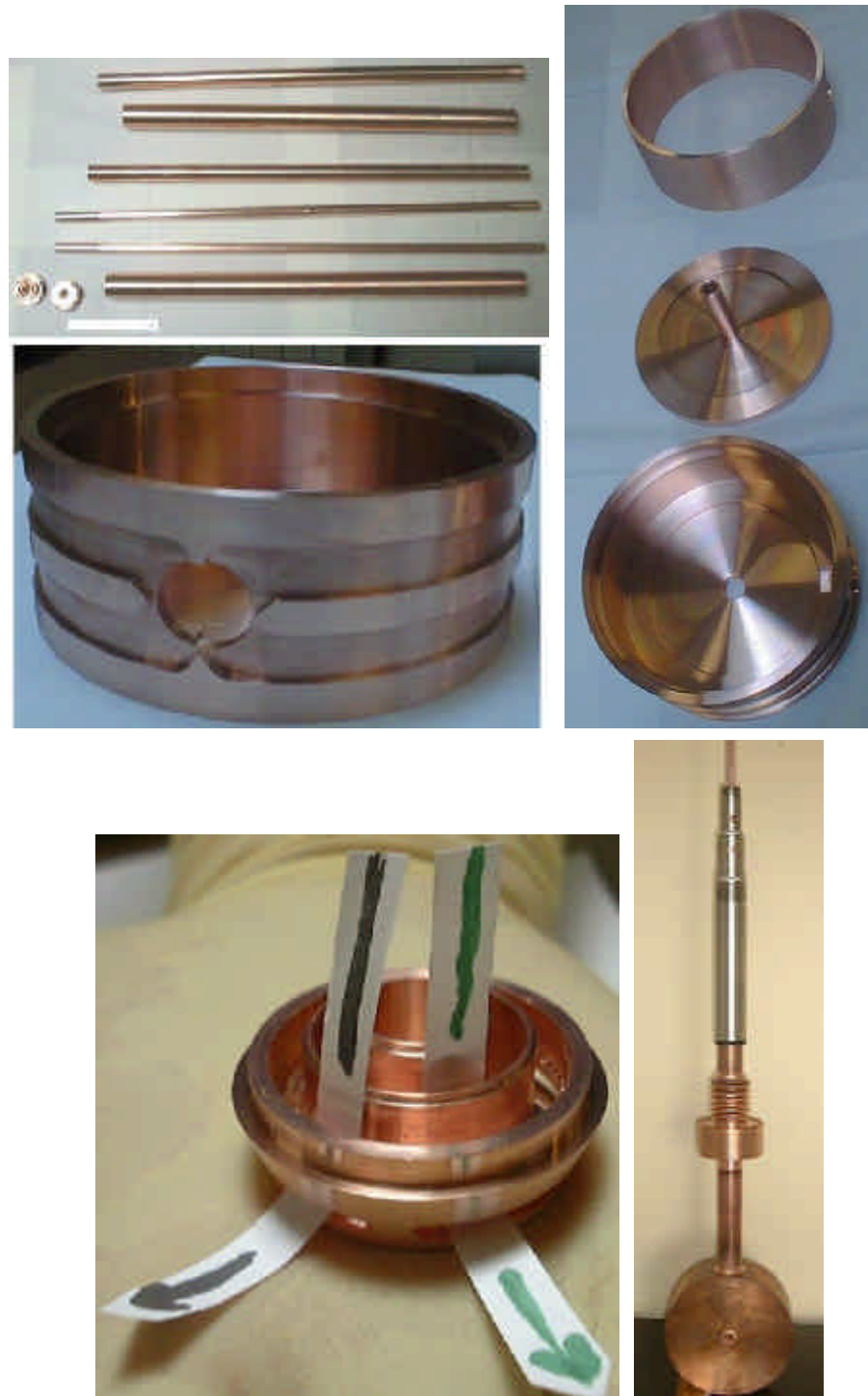
figure V-92 - Eléments constitutifs du tube de glissement pour aimant à conducteur creux. De gauche à droite et de haut en bas: les six tiges support (2x3) et les deux distributeurs de flux; les trois constituants du corps du tube de glissement; vue du détail du corps faisant apparaître les canaux de refroidissement et le trou destiné au distributeur de flux; le distributeur de flux; et l'ensemble après soudure et avant reprise d'usinage final.
