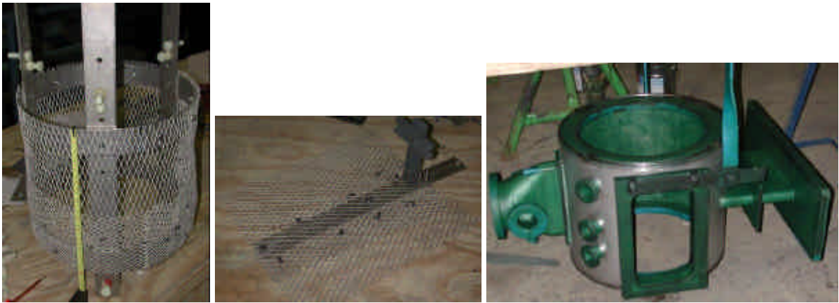
figure V-110 – Phase de cuivrage. Ci dessus à gauche et au milieu: anodes en platine sur titane pour le cuivrage interne de l'enceinte et du conduit HF respectivement; à droite: pièce avant cuivrage externe, avec système de préhension et d'amenée de courant et protection des faces. Ci dessous, de gauche à droite: bain de cuivrage, apparition de picots sur la face interne lors de l'opération de cuivrage externe malgré la peinture protectrice, et "fleurs" recueillies au cours du cuivrage externe (épais).
