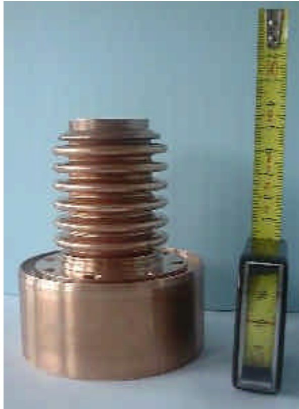
figure V-104 - Soufflet en cuivre sur son support pour essai mécanique.
