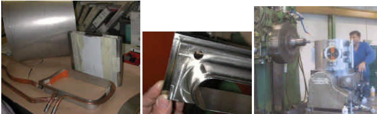
figure V-109 - Réalisation de l'enceinte en acier inoxydable.
