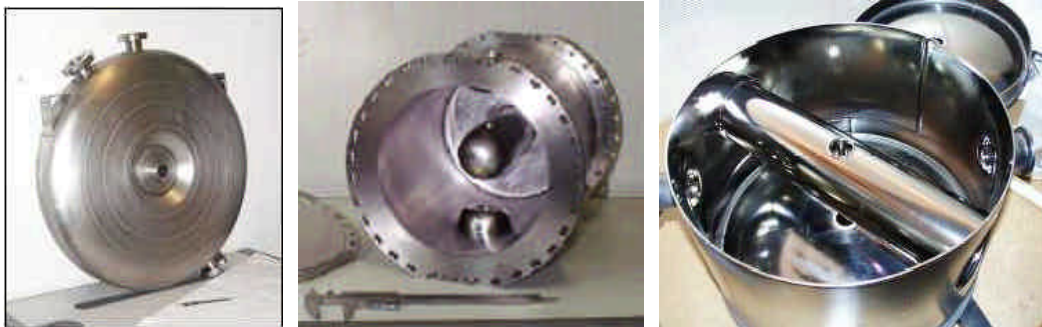
figure II-8 - Cavités supraconductrices pour protons d'énergie faible et intermédiaire. De gauche à droite: cavités ré-entrantes, résonateur quart d'onde et cavité à barreau.
