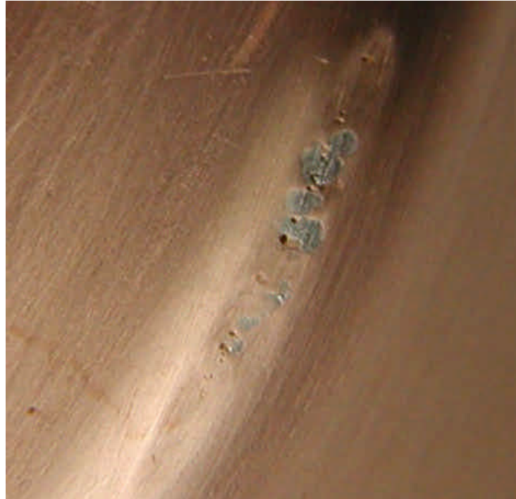
figure V-102 - Aspect des cratères après réparation partielle à la résine et martelage d'indium. Les cratères encore visibles n'ont pas été rebouchés car ils ne correspondent pas à des fuites.
