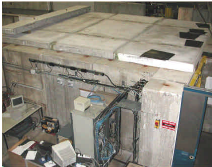
figure VI-126 – Vues générales de la zone de test. Ci-dessus: avant positionnement du toit; au premier plan le système amplificateur (pas encore connecté au guide d'onde) et en bas à droite la distribution d'eau avec le régulateur de pression; la maquette proprement dite se trouve en haut à droite, au bout du guide d'onde. La zone de contrôle / acquisition se trouve à gauche du mur. On distingue la bras rotatif permettant d'amener les câblages destinés aux systèmes solidaires de la poutre, ainsi que la chicane et la porte blindée imposées par la radioprotection. Ci-dessous: la même zone après mis en place du toit. Le poste de contrôle au premier plan souligne l'importance du câblage.
