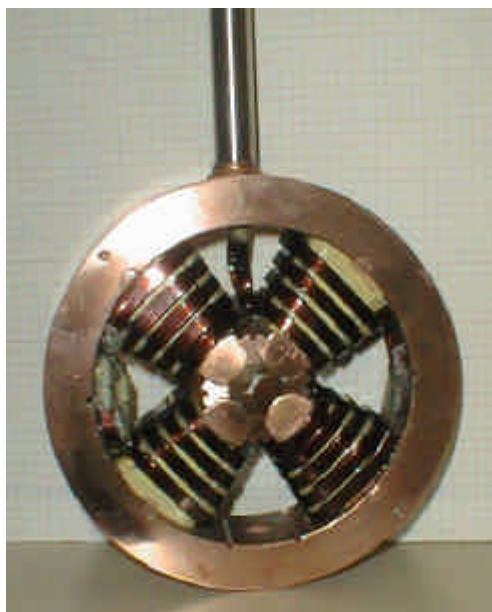
figure V-89 - Quadripôle à conducteur plein.
