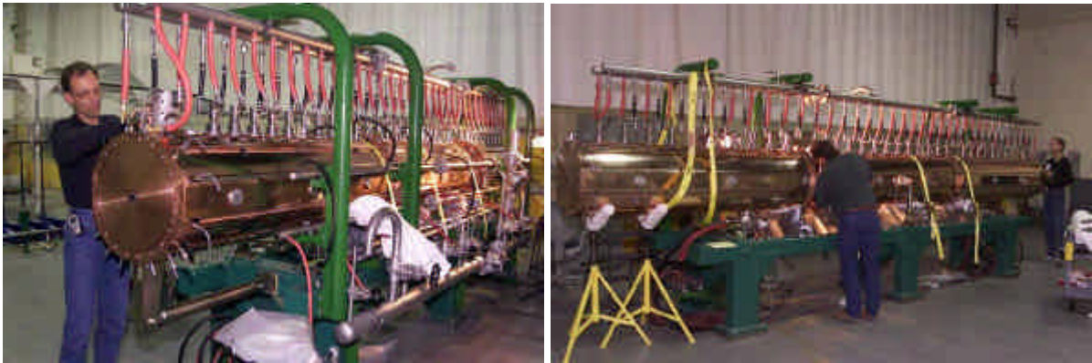
figure II-12 - Le DTL du projet SNS avant son installation sur site.
