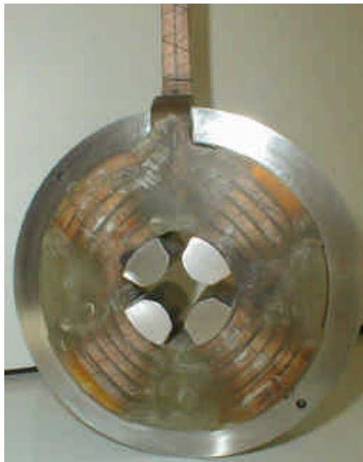
figure V-87 - Quadripôle à conducteur creux fini.
