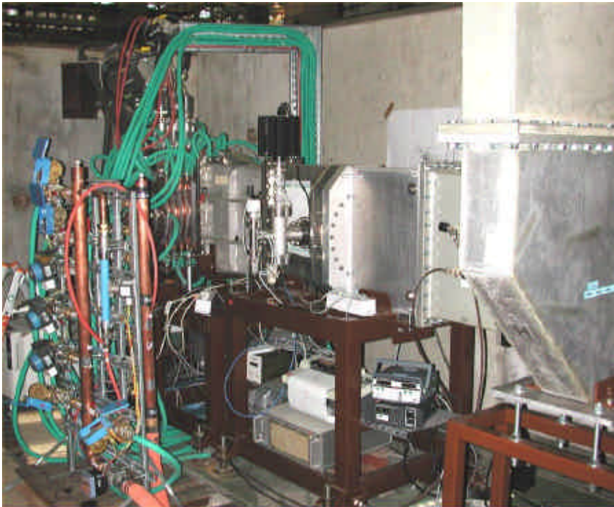
figure VI-127 - Implantation de la maquette proprement dite. Ci dessus: la maquette se trouve au fond; au premier plan à gauche la distribution d'eau sur les différents circuits. La fenêtre Thomson se trouve au milieu de la photo. Ci-dessous: on constate l'importance du refroidissement...
