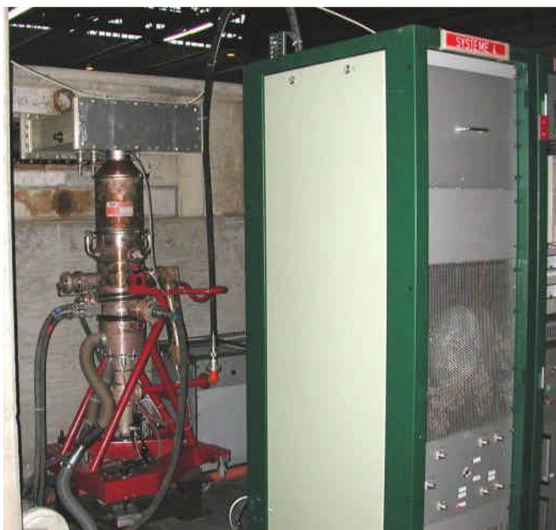
figure VI-123 – Amplificateur de puissance à tétrode utilisé lors des tests.
