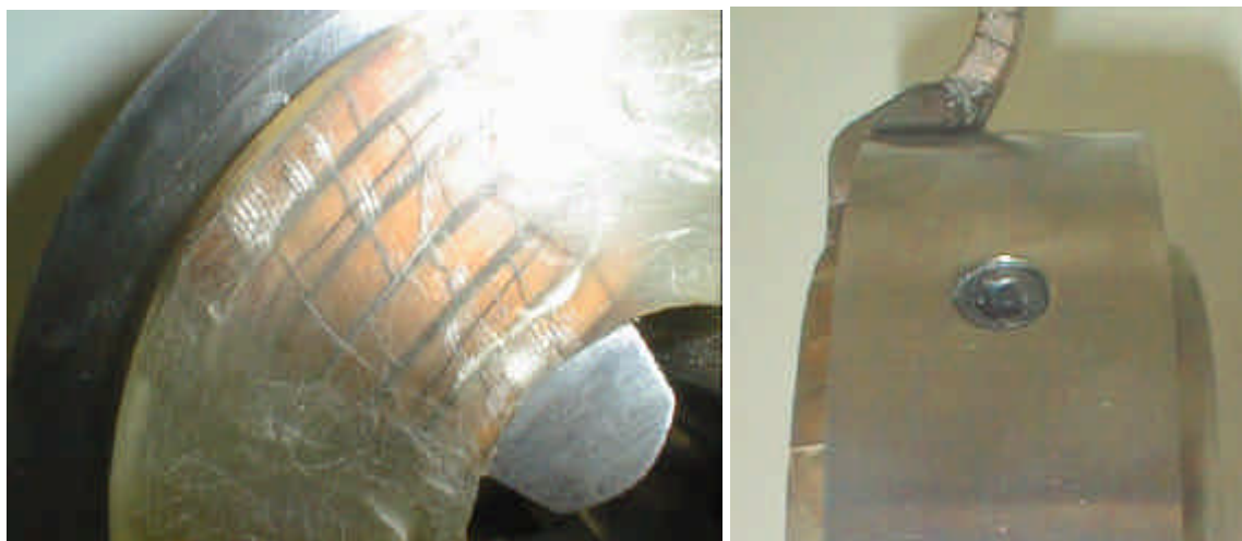
figure V-88 - Détails du quadripôle à conducteur creux. A gauche: vue serrée sur le bobinage; on distingue le pion de positionnement du pôle sur la culasse au dessus du bobinage, dans le plan de symétrie du pôle. A droite: vue de la culasse; cette vue met en valeur le mode de contournement de la culasse par les amenées de courant; au premier plan, on distingue parfaitement la vis de fixation d'un pôle sur la culasse.
