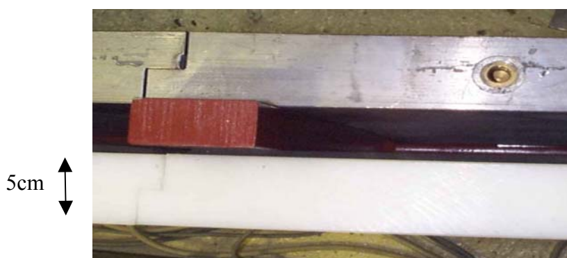
Figure 28 : photographie du blindage multicouche : plomb, carbure de bore, permaliboré
