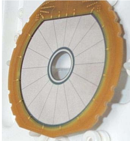
Figure 5.6 : Photo du détecteur silicium vu du côté des secteurs
