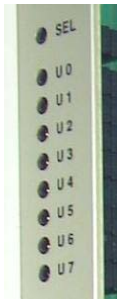
Figure 21 : Affectation des LEDs utilisateur de la face avant de la carte interface VME
