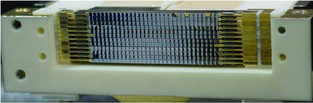
FIG. 1.16 – Plan focal de la caméra SHARC II : 12 \times 32 bolomètres pour la détection à 350 et 450 \mu\text{m} [Dowell 03].
