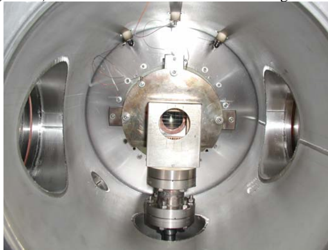
Figure 53 : Photo du profileur dans l'enceinte de la ligne basse énergie.
