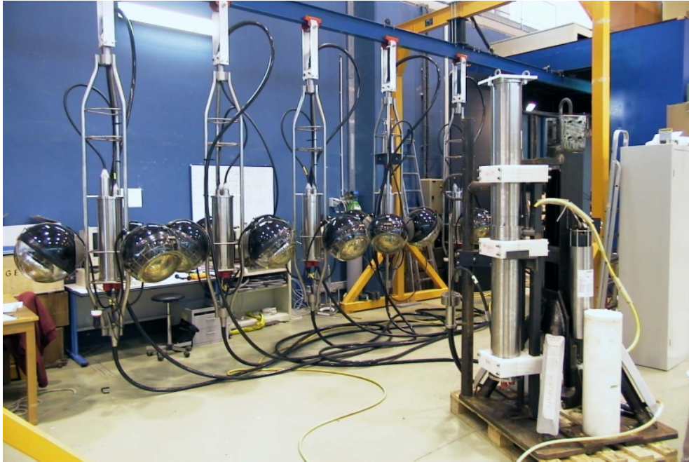
Figure E-4 : Photo de la ligne secteur à Marseille. Les cinq étages et le câble électro-optique sont visibles en arrière plan alors que la base contenant l'électronique de contrôle lent et la distribution de puissance est en avant plan. Le prototype est prêt à être installé dans la chambre noire (salle bleue à droite de la photo) pour une série de tests.
