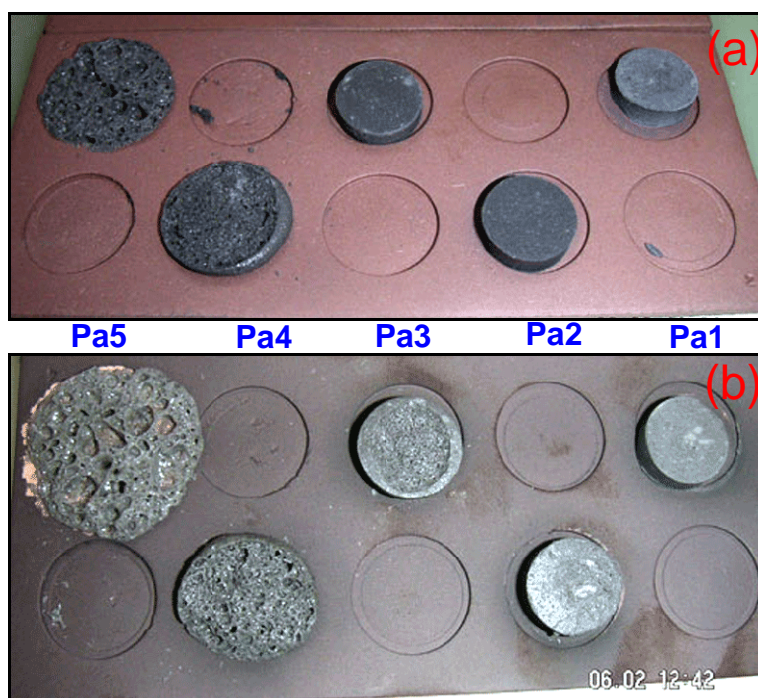
Photo 5. Pastilles de poudres compressées après le traitement thermique à 660°C (a) et 720°C (b).
