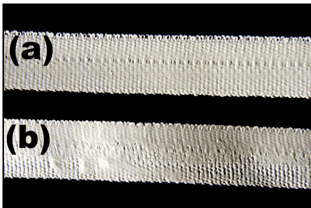
Photo 13. Comparaison d'imprégnation pour la composition (J) avec deux stocks d'argile Expans différents: premier stock (a), deuxième stock (b).
