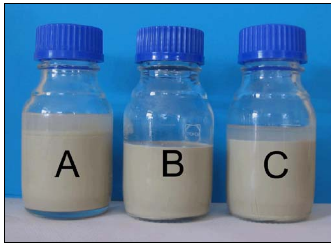
Photo 6. Comparaison des suspensions de composition A,B et C de montmorillonite Arvel après 12 heures de repos: la fritte de verre sédimente plus rapidement que dans le cas du kaolin BIP.
