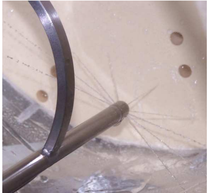
Figure 22 –Orientation des perçages de la buse HPR.
