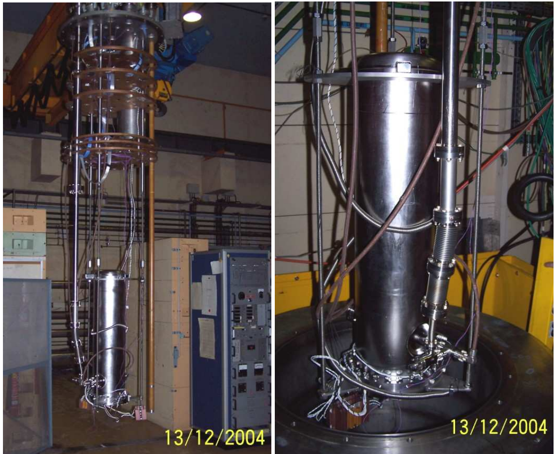
Figure 24 – La cavité sur son insert lors de son positionnement dans le cryostat vertical.
