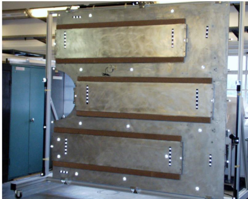
**FIG. 6.26:** Maquette de la partie centrale d'une chambre de la station 5 utilisée pour les tests de photogrammétrie.
