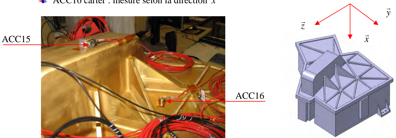
Figure 4-17 : Position des accéléromètres sur le carter
