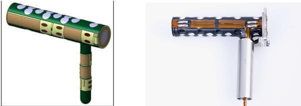
Fig. 8.3 – Simulation et conception de la cellule avec les chauffettes.
