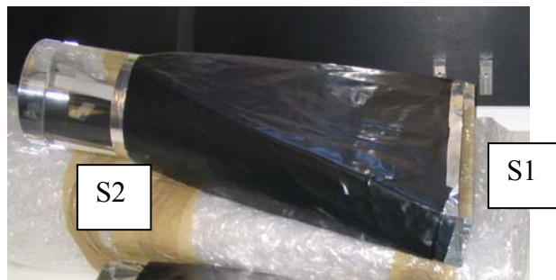
FIG. 3.7 - Guide de lumière tronconique avec son habillage.
