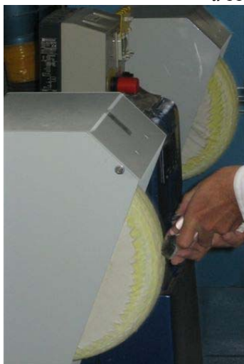
FIG. 5.3 - Polissage des cylindres qui serviront d'interface avec le PMT
