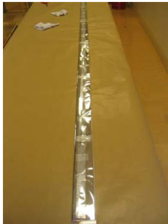
FIG. 3.4 - Le scintillateur est recouvert complètement par le film réfléchissant
