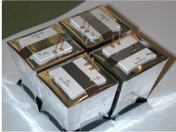
FIG. 2.8 – À gauche, configuration en étage de détection des CsI de MUST2. À droite, quatre CsI sont enrobés dans du Mylar aluminisé et les photodiodes collées sur la face arrière.
