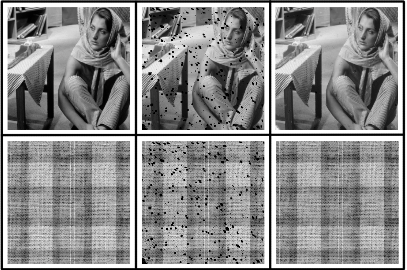
FIG. 3.8: Inpainting sur deux images différentes. L'une sans motifs réguliers de manière globale, l'autre avec. On constate que la DCT reconstruit très nettement l'image régulière tandis qu'elle ne reconstruit pas aussi bien barbara .
