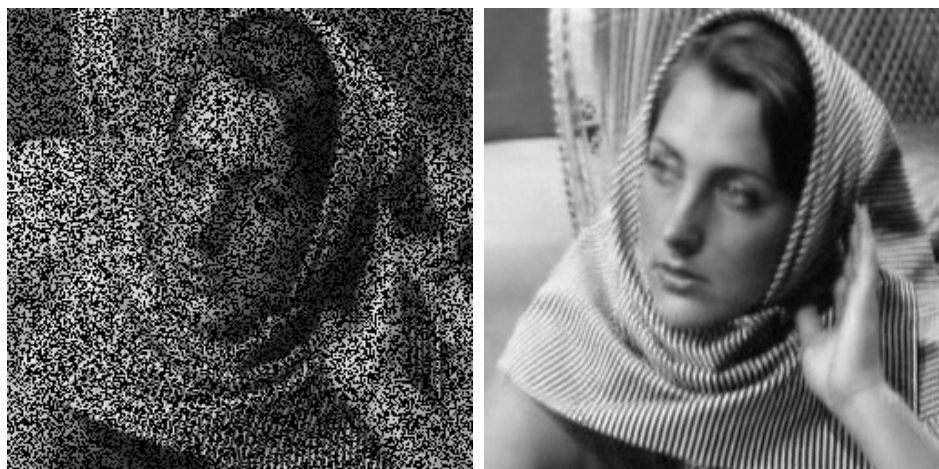
FIG. 3.1: Un inpainting est appliqué sur une image à laquelle il manque 50% de ses pixels.
