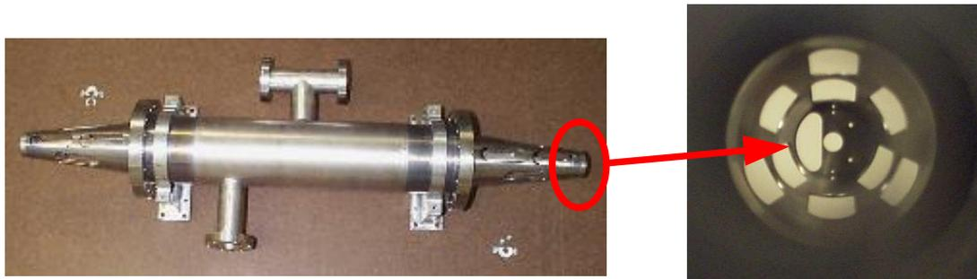
Figure II.8: Photos de la cavité. La photo à gauche montre le corps de la cavité ainsi que les supports des miroirs à chaque bout (cercle rouge). La photo de droite montre une vue de face de support du miroir (petit cercle central) et du passage du faisceau d'électrons (forme oblongue verticale).
