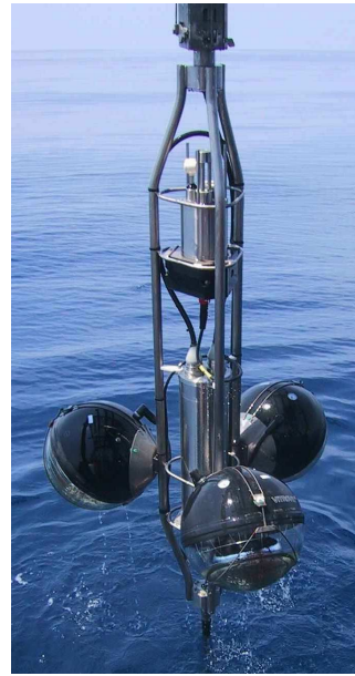
FIGURE II.17 – Photo d'un étage avant son immersion, on peut y voir les trois modules optiques et le module de contrôle local.
