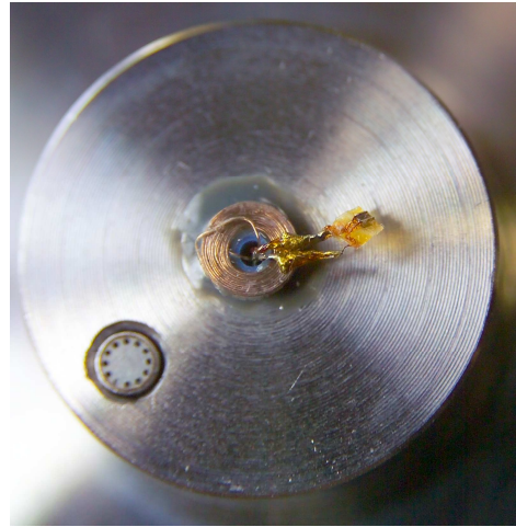
Figure IV.13 Photo du support porte échantillon avec capteurs de température, de pression et le chauffeur
