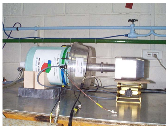
Fig. 2.5 – Détecteurs "clover" en test à Saclay. Gauche : détecteur de taille EUROGAM. Droite : détecteur prototype EXOGAM.
