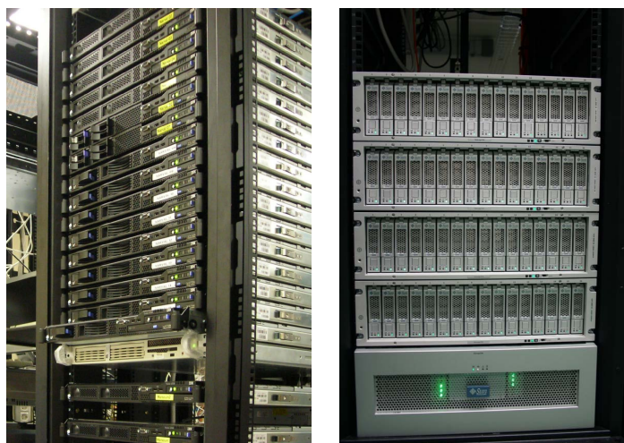
Fig. 2.14 – Gauche : serveurs “pizza boxes”. Droite : serveur de disques.
