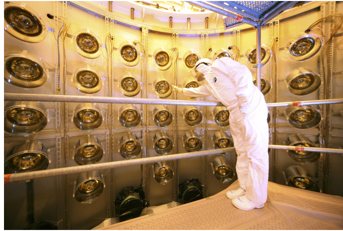
FIGURE 3.10 – Photographie du détecteur lointain avec vue de l'intérieur de l'enceinte buffer. On peut distinguer la répartition des PMs sous forme d'anneaux ainsi que leur blindage en \mu -métal.
