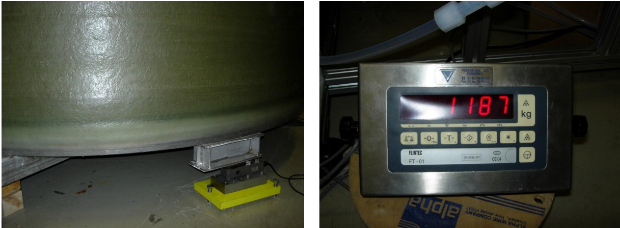
FIGURE 6.1 – À gauche : photographie d'un des trois capteurs de force FLINTEC SB5-C3-50kN. On peut apercevoir la plaque métallique et le système de trois vis permettant d'assurer le réglage de la planéité. À droite : lecture de la somme cumulée des trois masses sur l'écran d'affichage.
