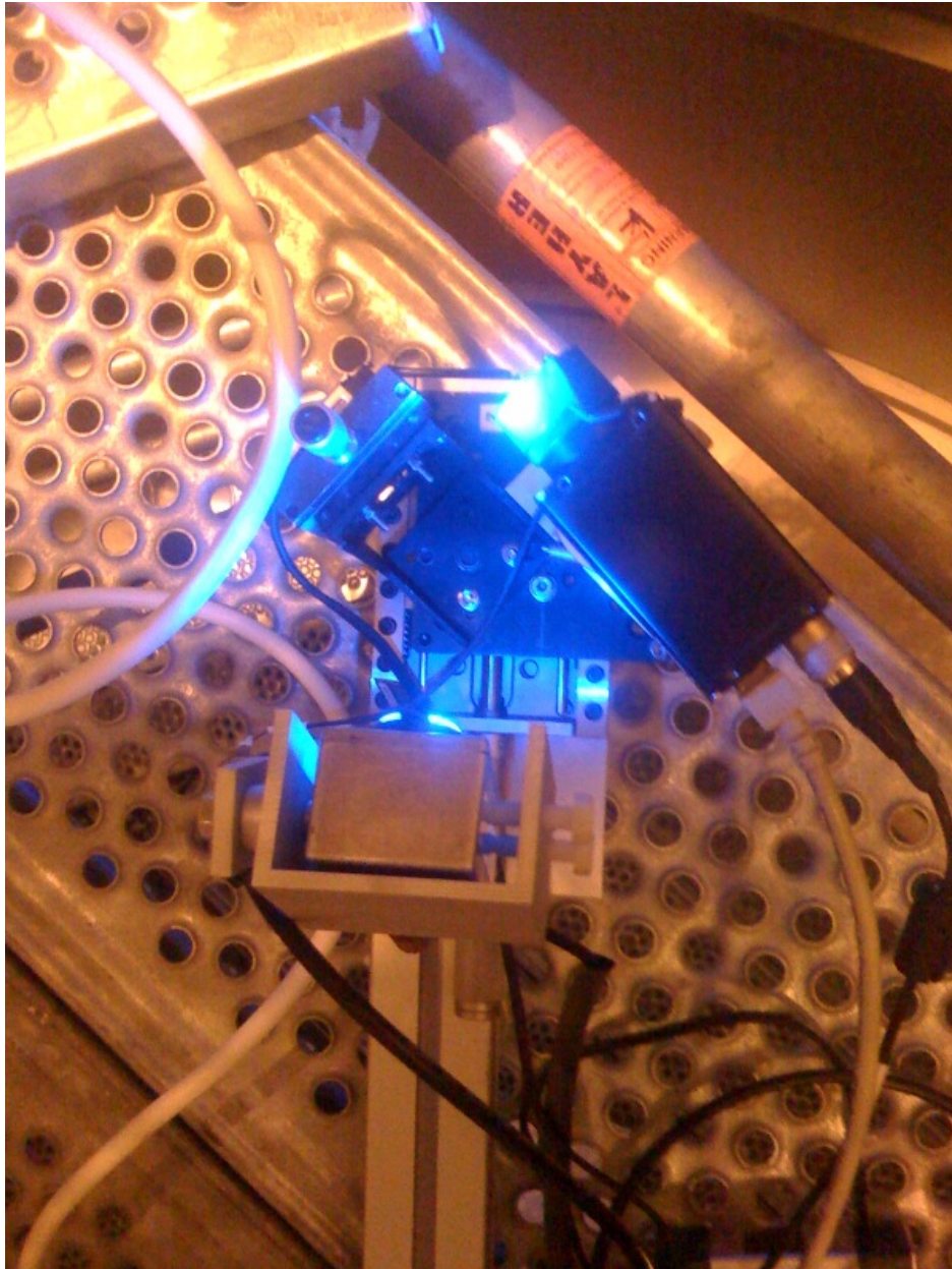
FIGURE 4.9 – Dispositif expérimental de mesure de réflectivité mis au point au synchrotron Soleil.
