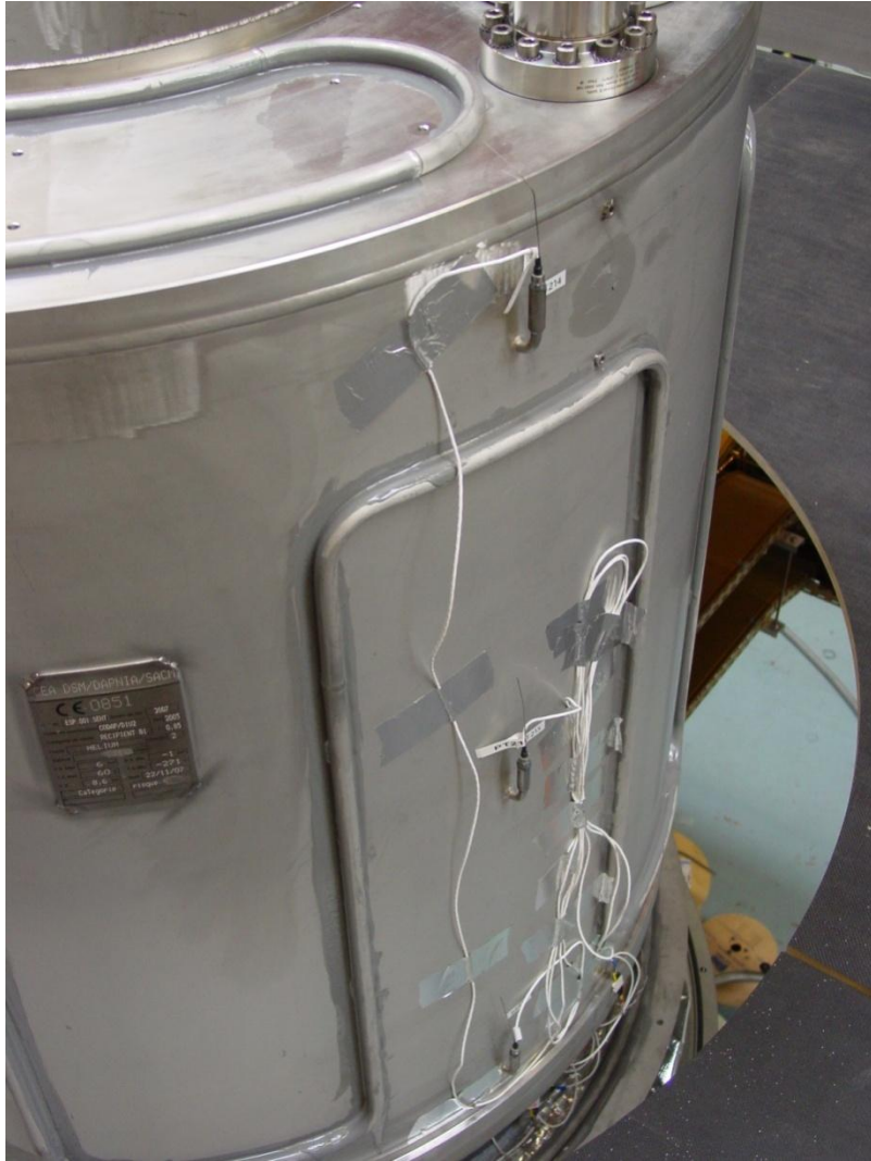
Figure 3.18 – Photo des capteurs de pression externes soudés sur l'enceinte à vide du tank hélium de l'aimant Seht
