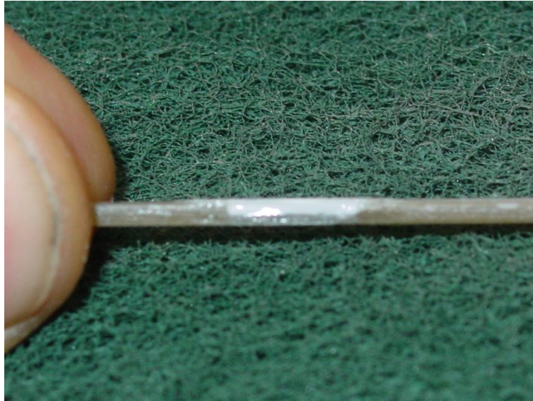
Figure 3.4 – Photo d'une chaufferette après avoir été recouverte de colle
