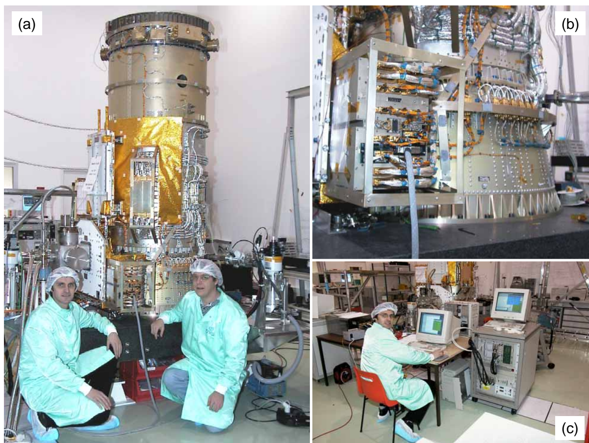
FIGURE 4.2 – Photos du test d'intégration du modèle de vol de SPI au CNES à Toulouse en l'an 2000. (a) le modèle de vol de SPI sur son marbre en salle blanche avec B. Cordier et S. Schanne, (b) le modèle de vol du DFEE intégré sur SPI, on aperçoit branché sur le module nominal la sortie spy (gros câble gris) dont le rôle est d'espionner le dialogue HSL et LSL du DFEE avec le DPE de SPI, (c) station de pilotage de l'EGSE du DFEE et station d'analyse des données acquises par la sortie spy .
