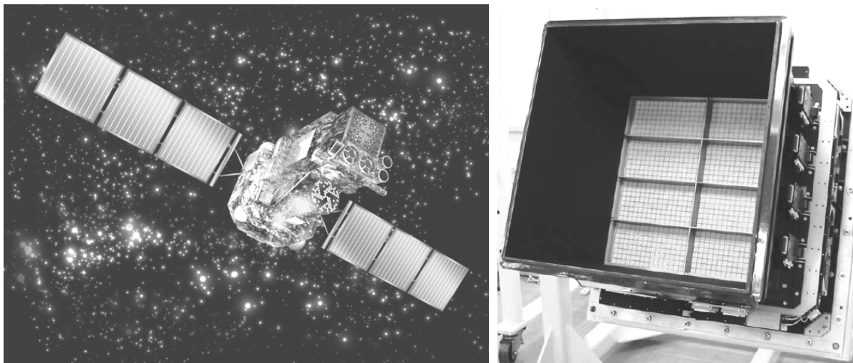
Figure 2.22 — Vue d'artiste du télescope spatial INTEGRAL en orbite (à gauche) et imageur ISGRI (à droite).
