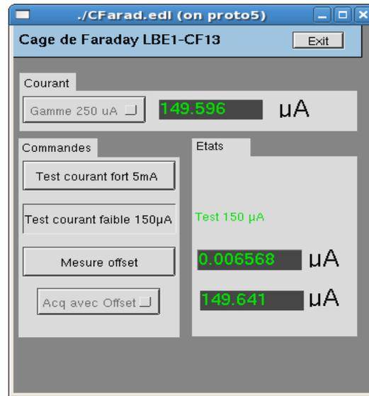
Figure 46 : Panneau de test CF11 (EDM)
