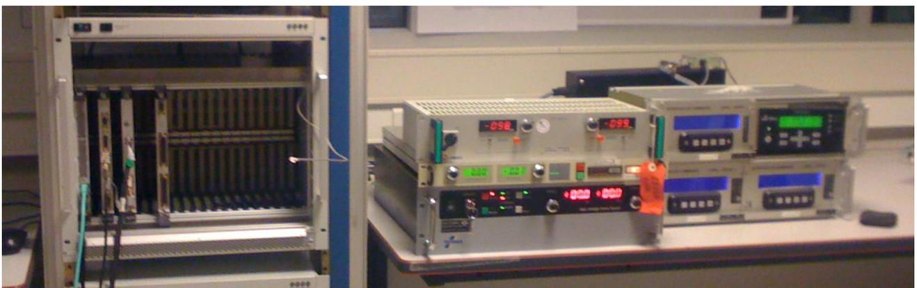
Figure 53 : Banc de test pour simuler le contrôle/commande de la source deuton
