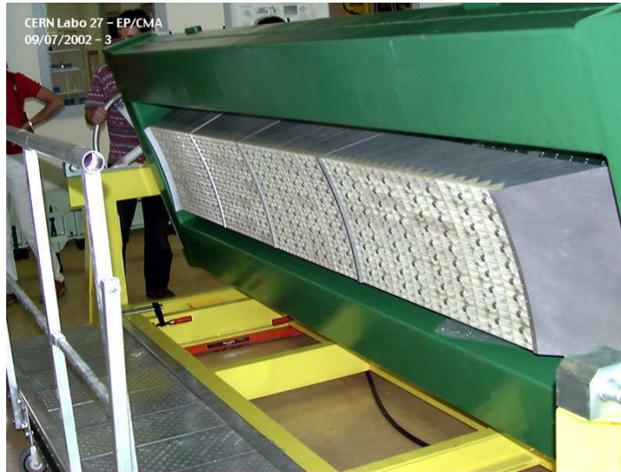
FIGURE 2.4 – Super-module du ECAL sur banc de test.
