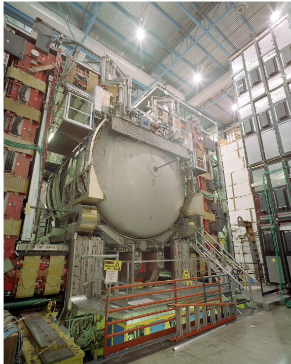
FIGURE 3.1 – Photo du détecteur DØ ouvert où il est possible de voir le toroïde (en rouge) entourant le calorimètre (au centre), traversé par le tube à vide, ainsi que des scintillateurs du spectromètre à muons (à droite).
