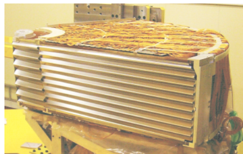
FIGURE 2.21 – Module appartenant à une des parties bouchon du calorimètre électromagnétique. L'axe du faisceau est vertical.
