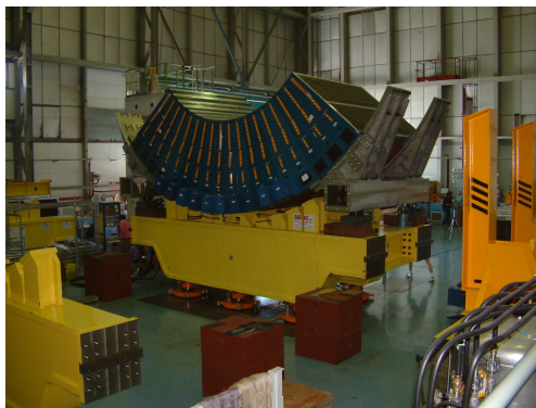
FIGURE 2.26 – Un des tonneaux étendus lors de sa construction. On remarquera la segmentation dans le plan R - \phi .
