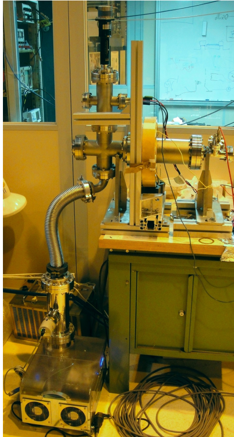
FIGURE 5.3 – Vue d'ensemble du montage de test du canon à électrons. Celui-ci se trouve dans la croix et tire vers l'écran fluorescent situé à l'extrémité droite de la chambre à vide. Le câble rouge sur la droite est l'alimentation en haute tension de l'écran et le flexible métallique relie le tout au groupe de pompage.
