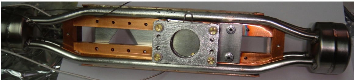
FIGURE 3.1 – Schéma et photographie du montage supportant la cible et le modérateur. Ce montage est inséré dans une chambre à vide à la sortie du linac. Il peut être translaté de manière à ce que le faisceau d'électrons incident irradie respectivement la cible centrale (équipée éventuellement d'un modérateur), une deuxième cible, sans modérateur (visible sur la droite) ou bien un dispositif d'étude du faisceau d'électrons (sur la gauche).
