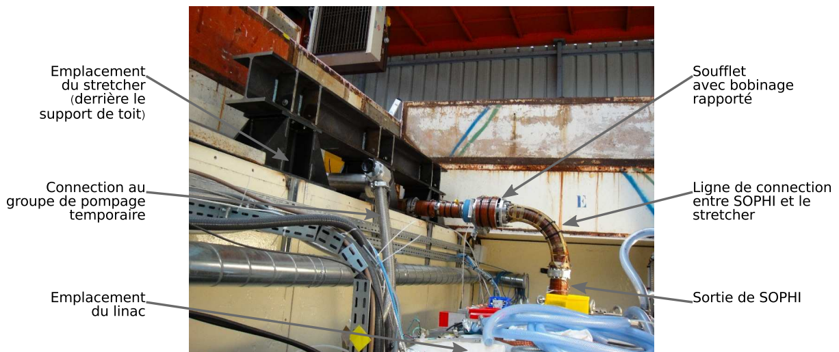
FIGURE 5.14 – Photographie de la partie de la ligne de positons reliant SOPHI au stretcher .
