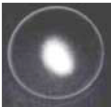
FIGURE 3.6 – Image de la tache faisceau dans la seconde section droite de la ligne de transport. Le cercle correspond à la MCP de diamètre 10 mm.
