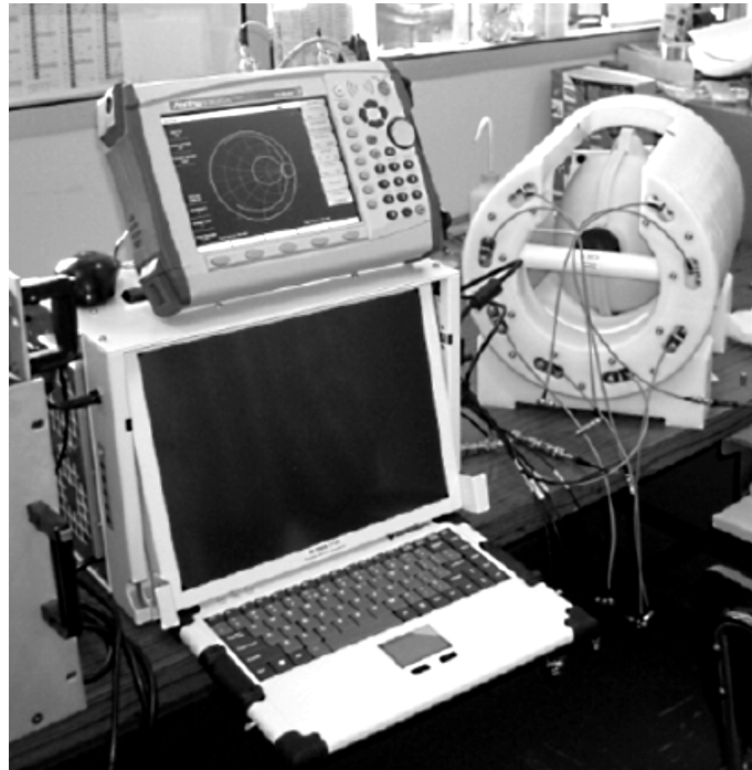
FIGURE 2.1.4: Dispositif de mesure des coefficients de la matrice [S] des antennes. En haut, l'analyseur de réseau vectoriel à 2 canaux mesure au choix la transmission et la réflexion. En dessous, l'ordinateur permet la commutation entre les canaux mesurés, et pilote l'analyseur.
