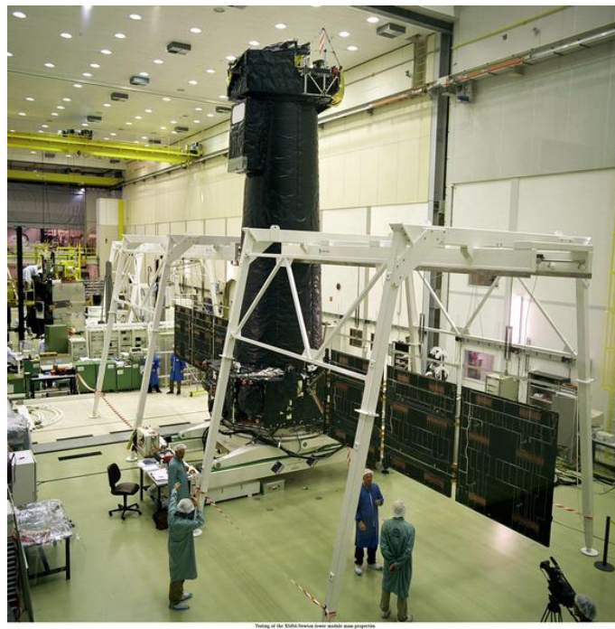
FIGURE 3.3 – Vue du satellite XMM lors de tests de déploiement de ses panneaux solaires à l'ESA/ESTEC. Image ESA.
