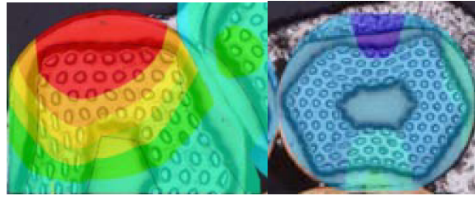
FIGURE 2.19 – Superposition du modèle éléments finis et d’une coupe de câble pour deux brins différents [83].
