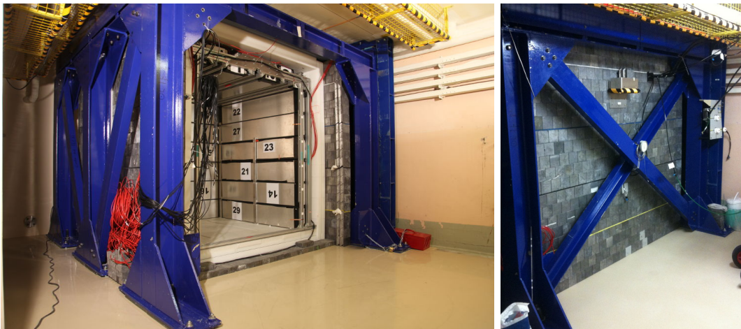
FIGURE 3.10 – Le détecteur Nucifer dans ses blindages. Le plan détaillé est en annexe D.1.
