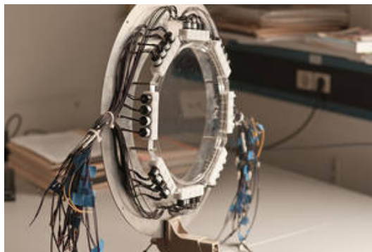
FIGURE 9.11 – Photographie d’un des scintillateurs utilisés pour mesurer le temps de vol des éjectiles en S4.
