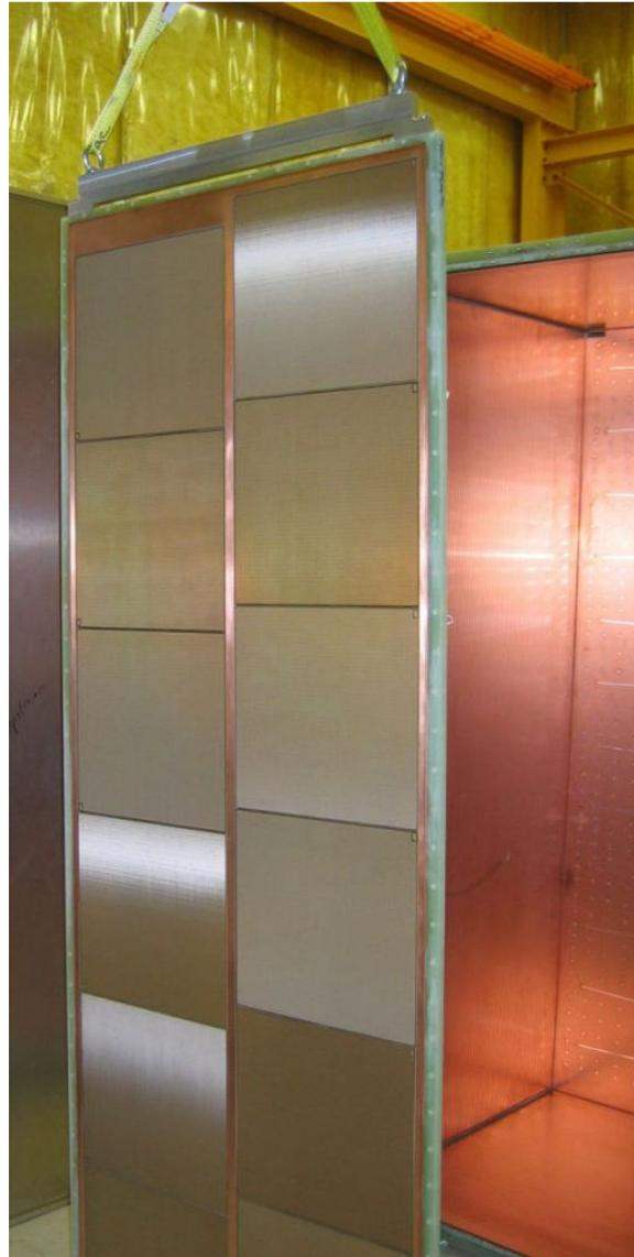
**Figure 3.24:** Disposition des douzes modules Micromegas sur un plan de lecture.
