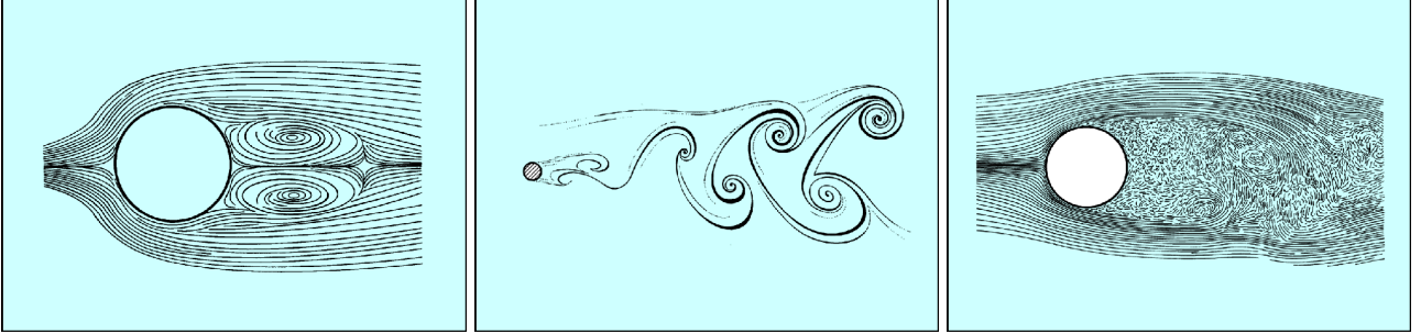
FIGURE 2.1 – Illustration de l’effet du nombre de Reynolds sur l’écoulement d’un fluide autour d’une paroi solide circulaire. La première image correspond au régime de recirculation tourbillonnaire ( 5 < Re < 50 ), la deuxième au régime de l’allée de Von Karman ( 50 < Re < 1000 ) et la dernière à un sillage turbulent ( Re > 1000 ). Crédits : http://ielnrx1.epfl.ch/e-lin/Ryhmimg/documents/chapters/documents-published/doc5/node116.html .
