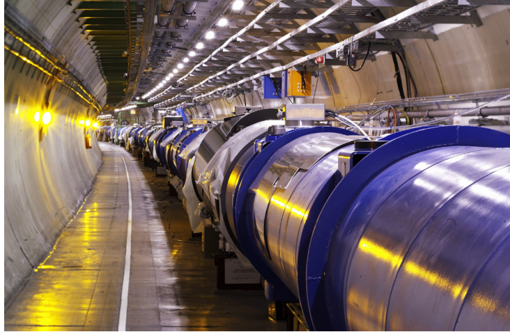
FIGURE 2.9 – Photographie des aimants supraconducteurs entourant la ligne de faisceau du LHC.
