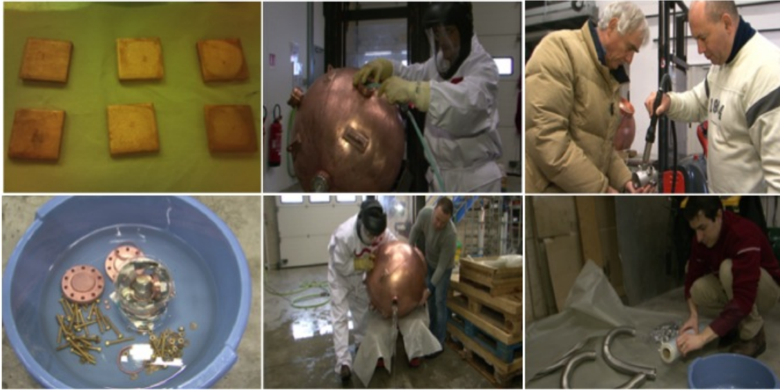
FIGURE 7.9 – Différentes étapes de la première intervention d'attaque chimique (en janvier 2013). La procédure de nettoyage a été testée sur des morceaux cubiques de cuivre identique à celui utilisé pour la fabrication de la sphère.
