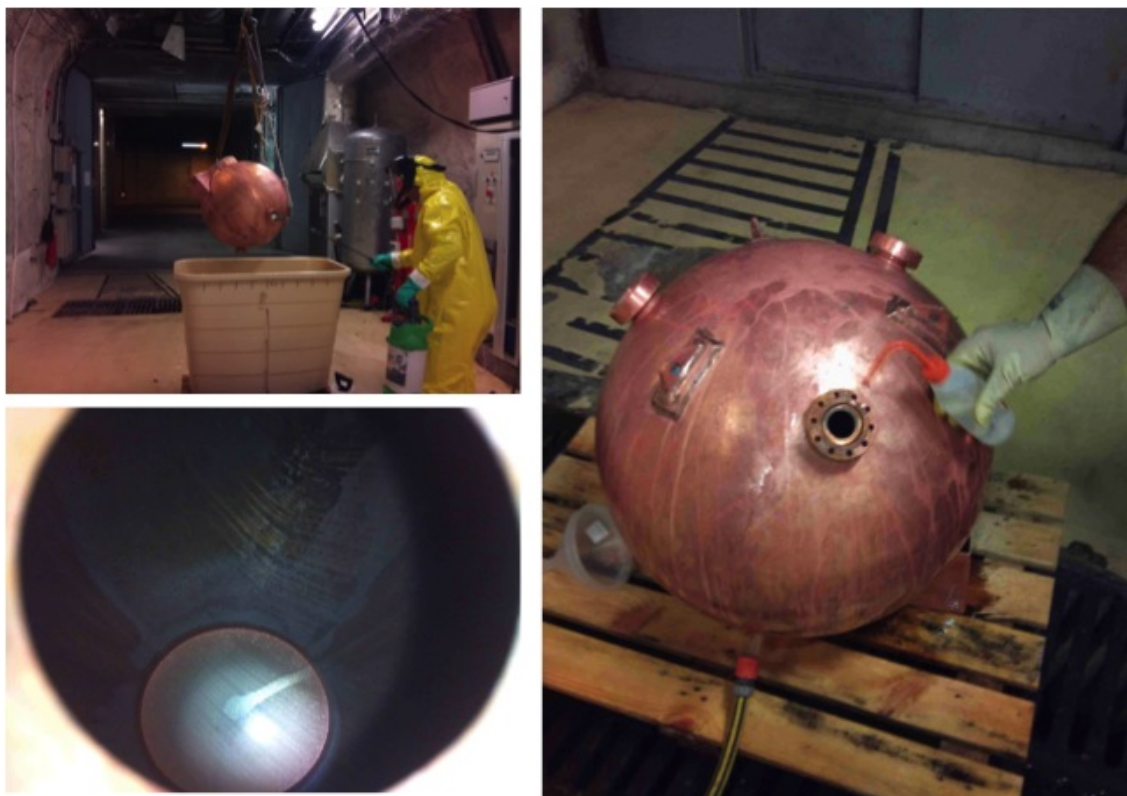
FIGURE 7.11 – Deuxième intervention d'attaque chimique (en octobre 2013), pour laquelle l'intérieur et l'extérieur de la sphère ont été pulvérisés avec une solution d'acide nitrique à 30 % ; l'image en-bas à gauche montre l'intérieur de la cavité sphérique.
