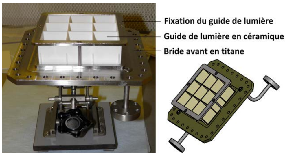
FIGURE V.4.2 – Étape intermédiaire du montage du démonstrateur optique version 2 : fixation du guide de lumière en céramique sur la bride avant en titane
