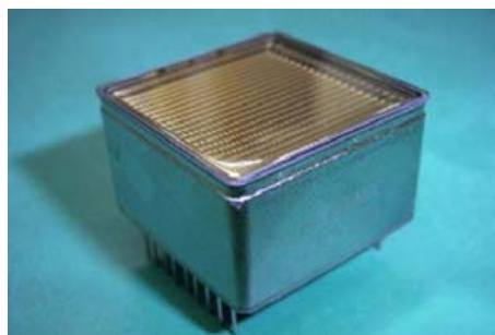
FIGURE II.1.10 – Vue d'un des 9 PMTs (Hamamatsu R11265-100) qui sont montés sur le démonstrateur optique.
