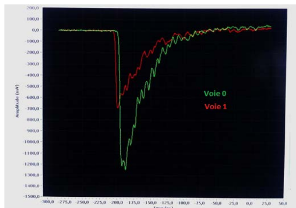
FIGURE III.3.3 – Visualisation des signaux des deux détecteurs YAP sur le logiciel d'acquisition.
