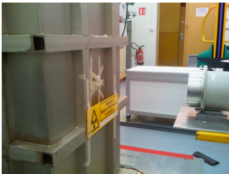
FIGURE 8.17: Photo du système expérimental de mesure d'une source en coïncidence entre le prototype à gauche et un détecteur externe à droite.
