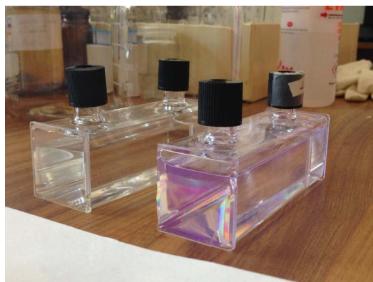
FIGURE 2.7: Photo d'une cellule en verre remplie de liquide scintillant (à droite) posée à côté d'une même cellule remplie d'eau (à gauche). La lumière naturelle excite le liquide qui devient fluorescent.
