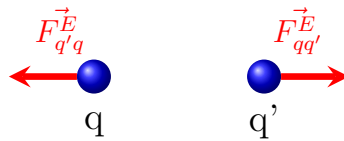
Figure 6.1 – Répulsion Coulombienne entre les particules du faisceau
