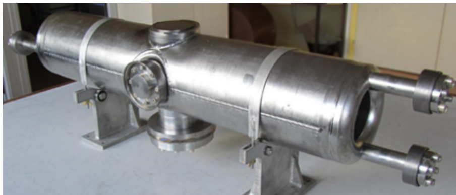
Figure 5.2 – Prototype de résonateur demi-onde
