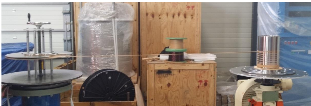
Figure V-22 : Vue d'ensemble de l'installation de bobinage de la double-galette chez SigmaPhi.
