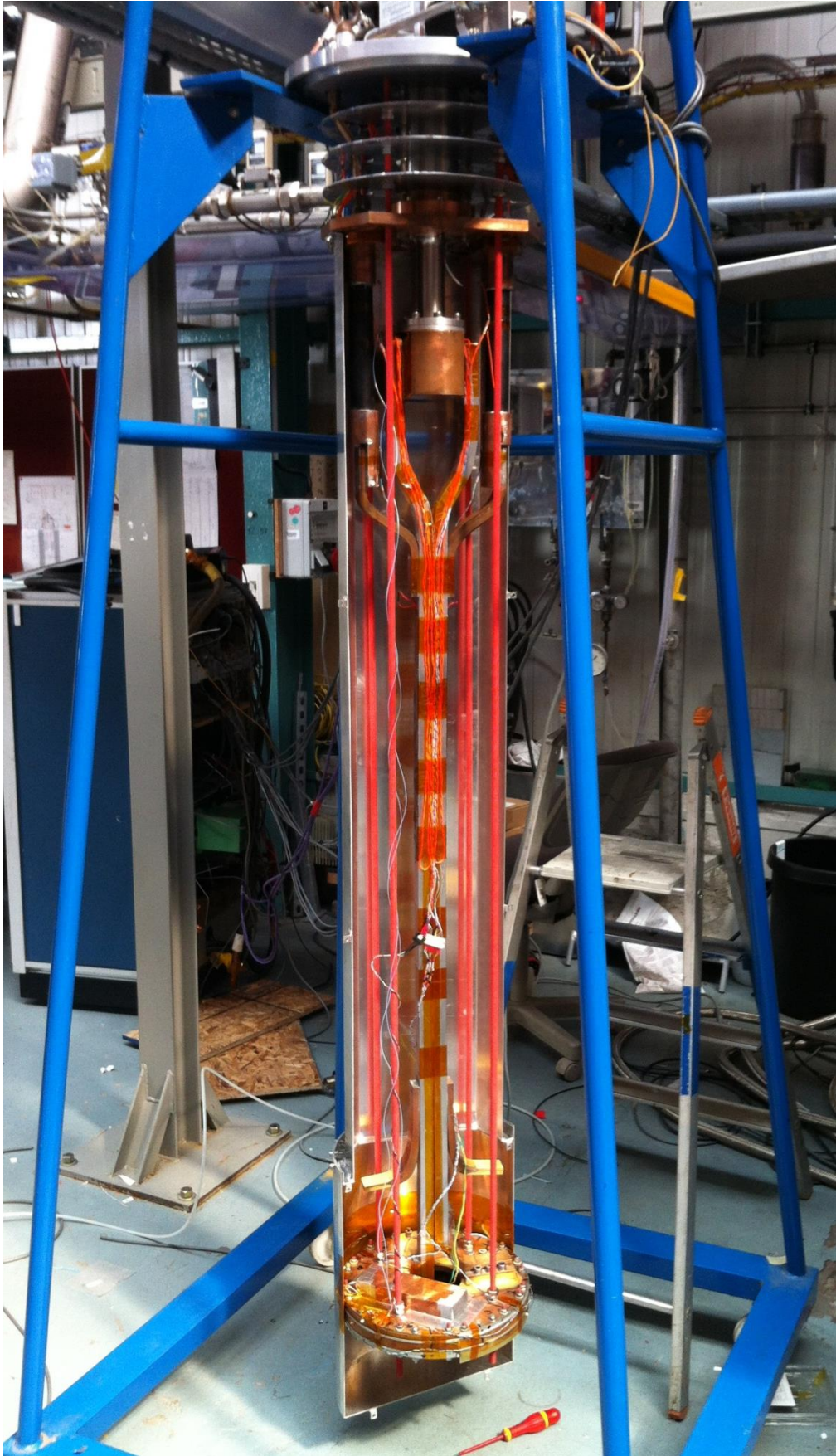
Figure II-35 : Vue de la deuxième version de l'insert froid avec le mandrin de test connecté.
