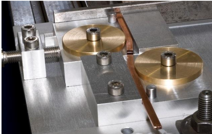
Figure V-14 : Outillage permettant de former un saut inter-galette (conducteur Iseult).
