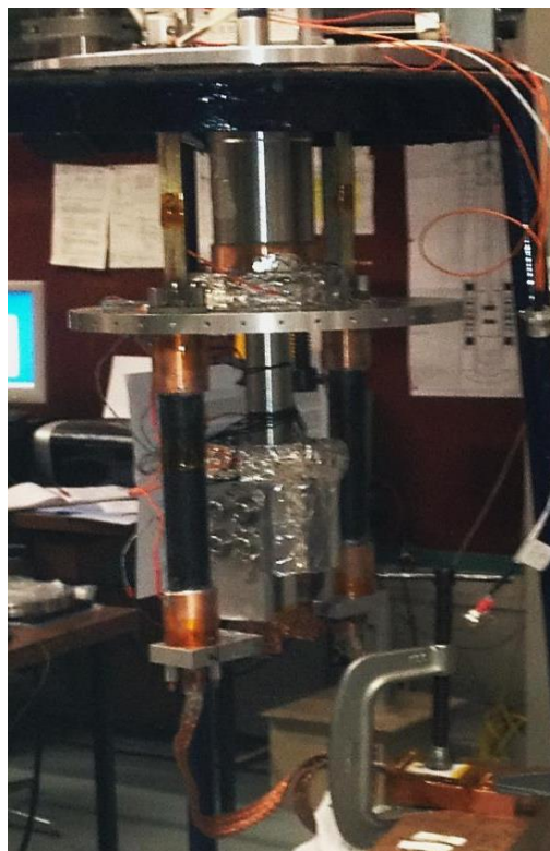
Figure II-21 : Vue des amenées de courant de l'insert froid en court-circuit pendant le collage des tresses en cuivre sur le drain thermique en cuivre.
