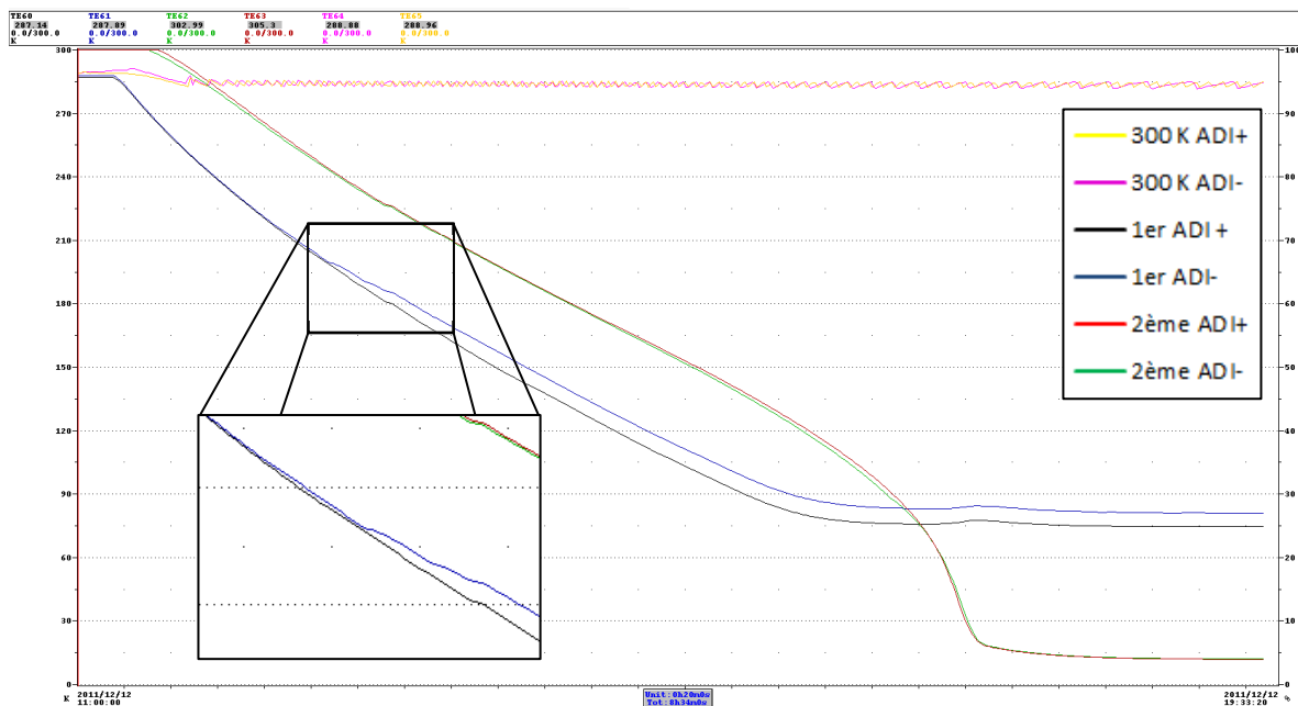
Figure II-22 : Courbes de mise en froid des amenées de courant lors de la première mise en froid de l’insert froid, un zoom des courbes montre “le moment” où les températures des amenées de courant sur le 1 er étage divergent.
