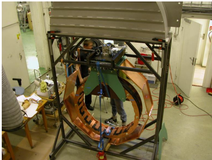
Figure I-7: Inducteur R & W en cours d'assemblage, conducteur ST.
